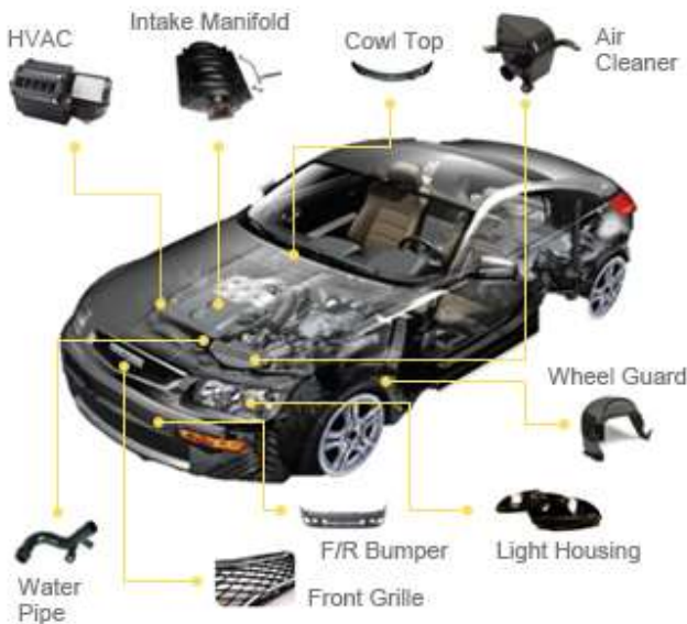
그림1. 동사의 금형으로 생산되는 자동차 내외장재
