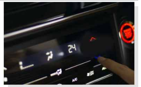
터치식 공조기 (HVAC)
